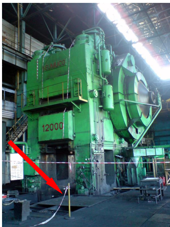
Рис.1 Общий вид ковочного пресса.
