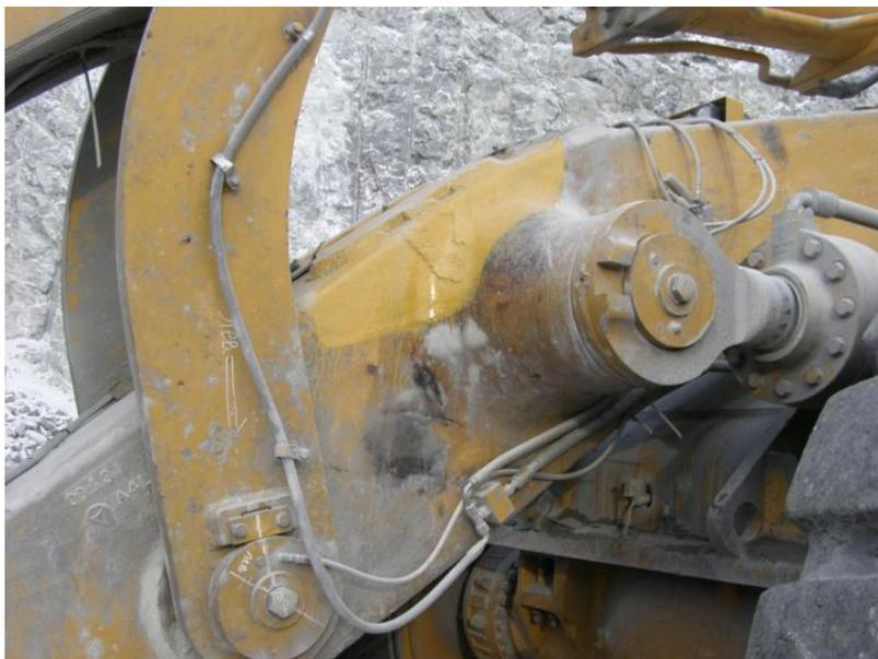
Заказчиком для проработки задачи были даны необходимые исходные данные (размеры, материал, условия работы и т.д.). После их анализа коллективом инженеров ООО «Сабарос» была разработана технологическая инструкция по ремонту трещин в стреле погрузчика с помощью штучных высоколегированных сварочных электродов марки Sabaros.
