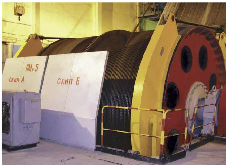
Рис.1 Общий вид тормозного барабана ШПМ.
