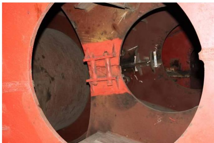
Рис.2 Трещина на ребре жёсткости барабана, скреплённая болтами
