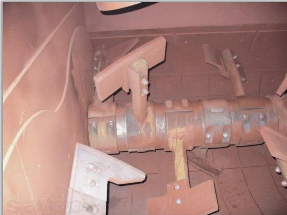
Рис. 1. Бетоносмесительная установка
