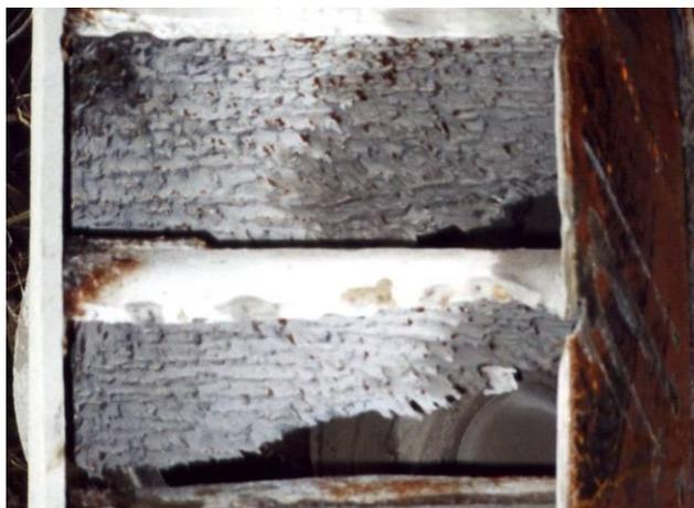
**Стойкость лопаток с наплавленным покрытием Sabaros FeCr увеличилась** при тех же условиях работы **в 7 раз**. На левой фотографии показан дымосос, снятый для ремонта с частичным износом покрытия. На правой фотографии тот же дымосос после ремонта. В месте наибольшего износа лопатки нанесено два слоя покрытия. В районе меньшего износа – сетка. На выходные кромки лопаток нанесено три слоя покрытия.
