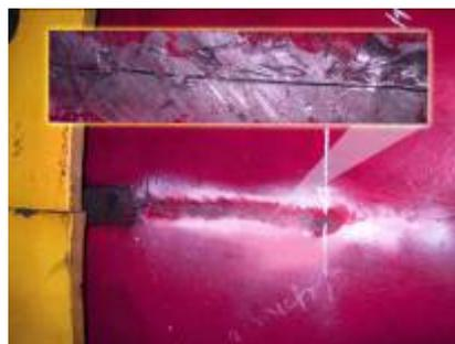
Рис. 4 Трещина по монтажному шву
