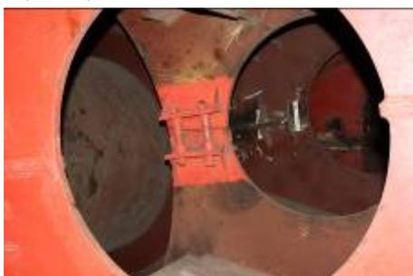
Рис. 3 Трещина по ребру жёсткости
