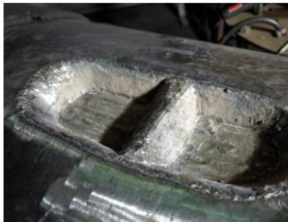
Рис. 6 Ремонт стенки гидравлического цилиндра
