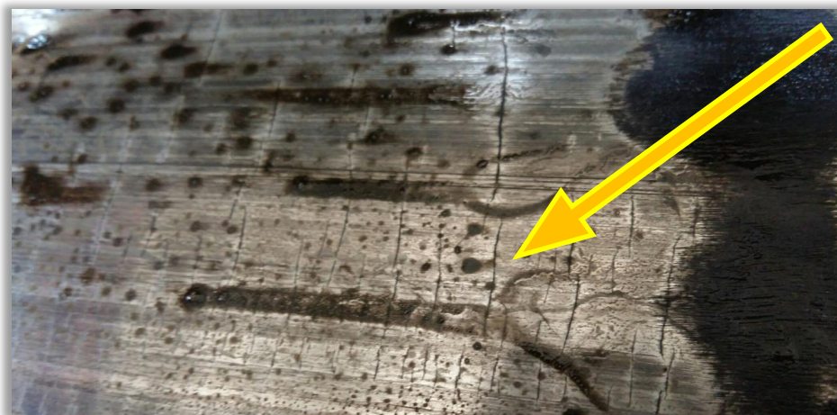
Рис. 2. Семейство трещин на рабочей поверхности тормозного поля
